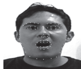
Figura 6. Puntos encontrados para una cara frontal con la boca abierta, una vez estabilizado
